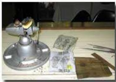
Schleifpapier vorsichtig entlang der Abrisskante im Schraubstock gespannt. Mit einem 1/4-Zoll-Dorn (altes Wellenendstück) kann der Propeller jetzt vorsichtig gebogen werden. Dieses sollte vorsichtig geschehen und immer wieder mit dem
