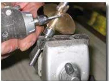
Form. Dann wird der Prop auf einem Dorn mit Hilfe von 2 Drivedogs festgespannt. Der Dorn wird dann in einem Schraubstock gespannt, um mit der Dremel und einem 3,17mm Hartmetallfräser (1/8'') einen Backcut zu machen. Dazu wird mit dem Fräser
